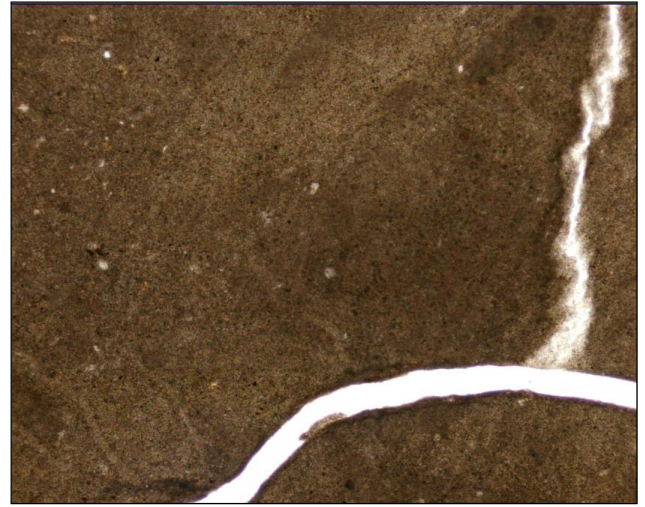
Figura 2 (izquierda): Texturas homogéneas: textura homogénea waxy cementada, formada por un esquelet granular de cuarzo de tamaño arena con matriz arcillosa carbonatada.
